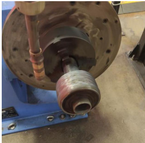
Figura 1 – Início do processo de impressão da roda do carro de medição
