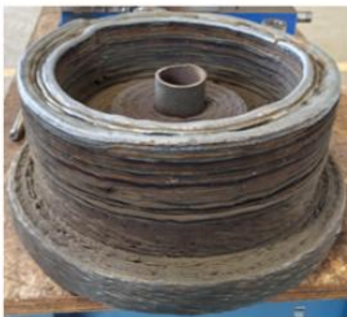
Figura 2 – Roda após o processo de impressão por WAAM
