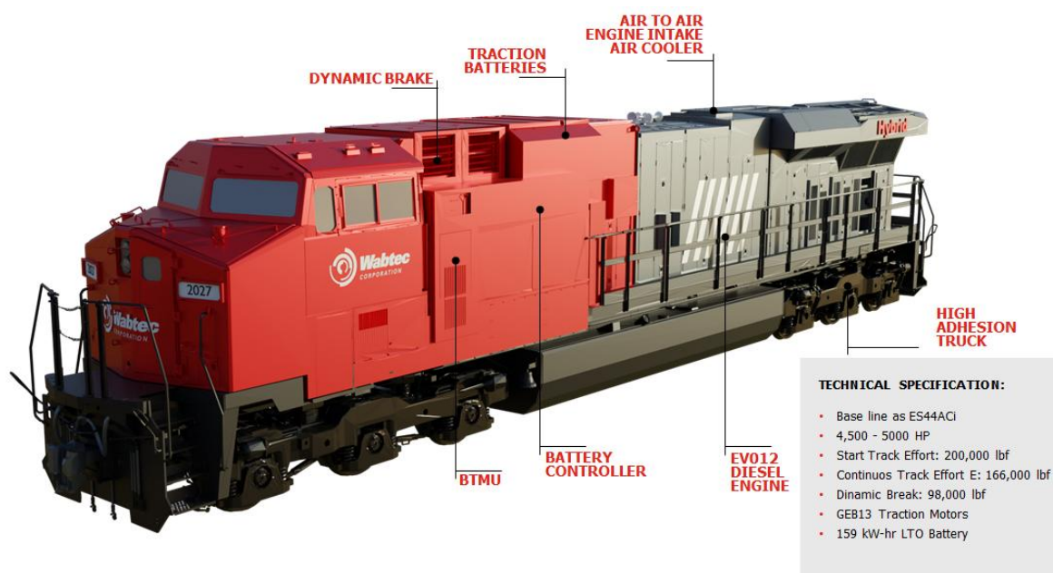
Figura 3 - Topologia da locomotiva híbrida
