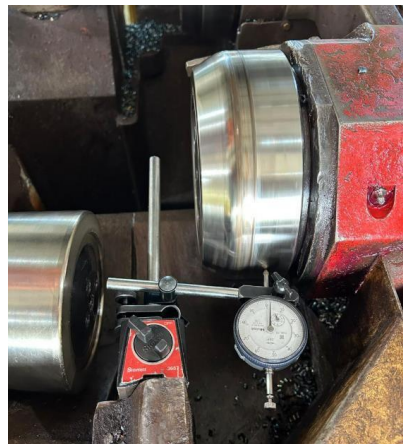
Figura 12 - Verificação de excentricidade do rolo
