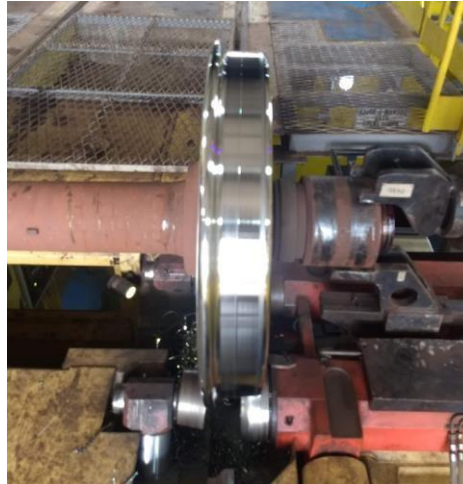
Figura 4 - Rodeiro ferroviário sobre o torno subsolo
