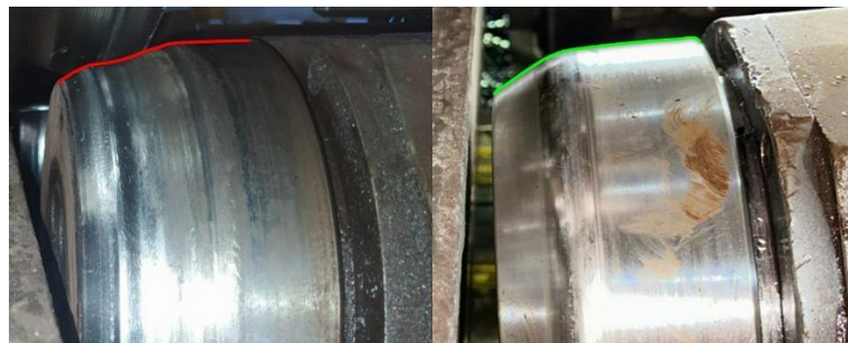
Figura 11 - Rolo de tração com perfil desgastado (esq.) e perfil novo (dir.)
