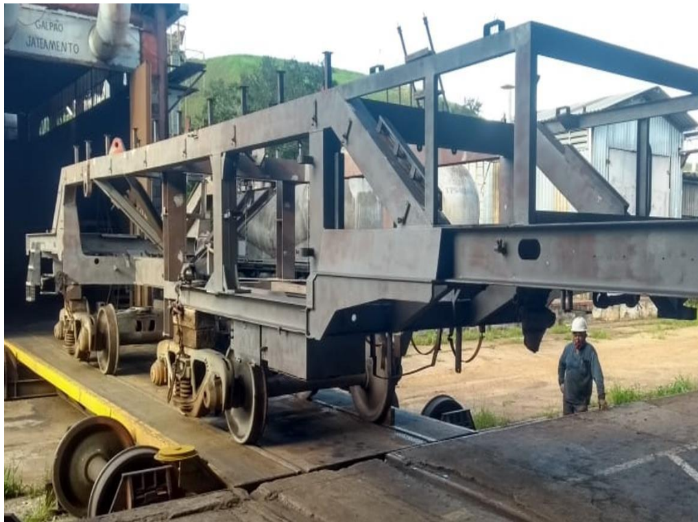
Figura 2. Socadora S-07 durante a revisão geral e modernização em Juiz de Fora.
