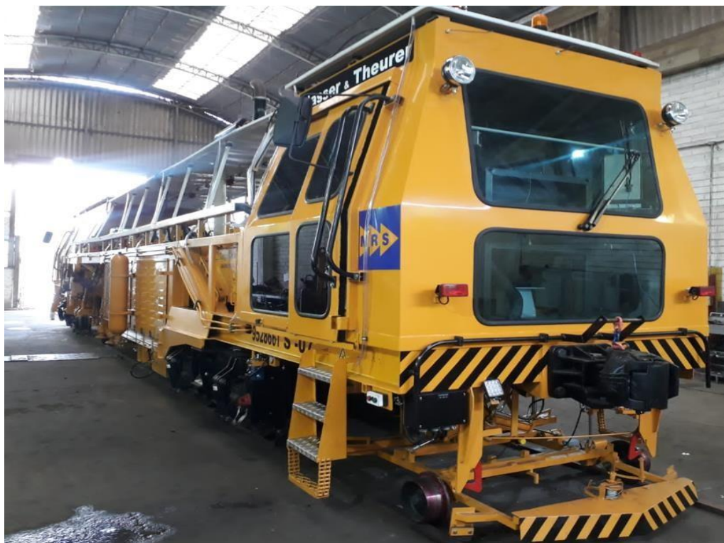
Figura 3. Socadora S-07 depois da revisão geral e modernização em Juiz de Fora.
