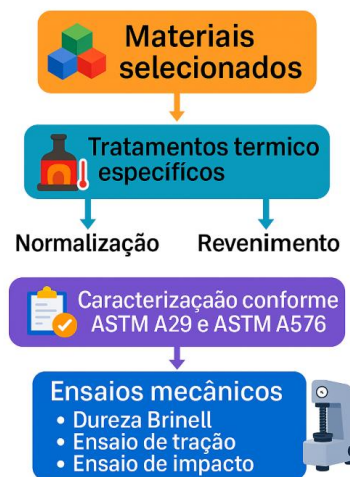
Figura 6. Seleção dos materiais para a construção mecânica
