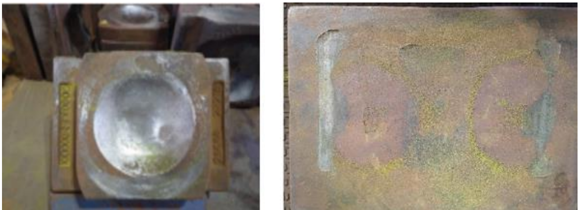
Figura 14. Medição do Desgaste após 675 dias de operação
